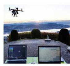
Bild: Multikopter mit Steuerungs- und Auswerteeinheiten
