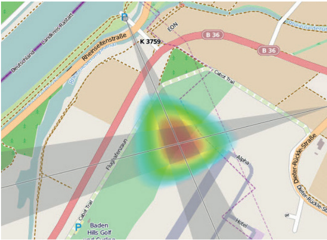
Sección transversal del ángulo de llegada / mapa de calor del ángulo de llegada
